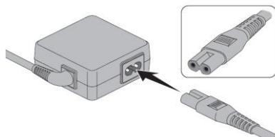
*Свързване на зарядния кабел към адаптера за променлив ток (щепсел с 2 щифта)*
